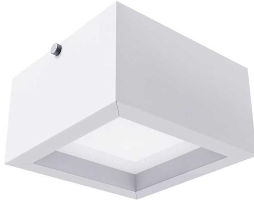
Luminária quadrada de sobrepor, 28W 4000K IRC>80. Corpo em alumínio. Acabamento branco, preto ou especial. Controle óptico principal através de difusor em poliestireno translúcido. Luminária grau de proteção IP-20. Driver corrente constante Liga/Desliga, Triac, 1-10V ou Dali (consultar condições). Tensão de trabalho 220V ou Bivolt.
