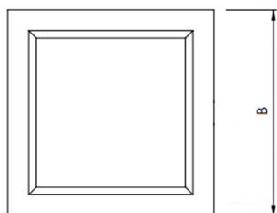
Luminária quadrada de sobrepor, 7W 2700K IRC>80. Corpo em alumínio. Acabamento branco, preto ou especial. Controle óptico principal através de difusor em poliestireno translúcido. Luminária grau de proteção IP-20. Driver corrente constante Liga/Desliga, Triac, 1-10V ou Dali (consultar condições). Tensão de trabalho 220V ou Bivolt.
