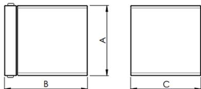
Luminária quadrada arandela iluminação direta, 4W 2700K IRC>80. Corpo em alumínio. Acabamento Branca, Preta ou Especial. Controle óptico principal através de facho Difuso Direto. Luminária grau de proteção IP-20. Driver corrente constante Liga/Desliga Tensão de trabalho 127V ou 220V.
