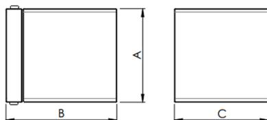
Luminária quadrada arandela iluminação direta e indireta, 8W 5000K IRC>80. Corpo em alumínio. Acabamento Branca, Preta ou Especial. Controle óptico principal através de facho Difuso Direto e Indireto. Luminária grau de proteção IP-20. Driver corrente constante Liga/Desliga Tensão de trabalho 127V ou 220V.
