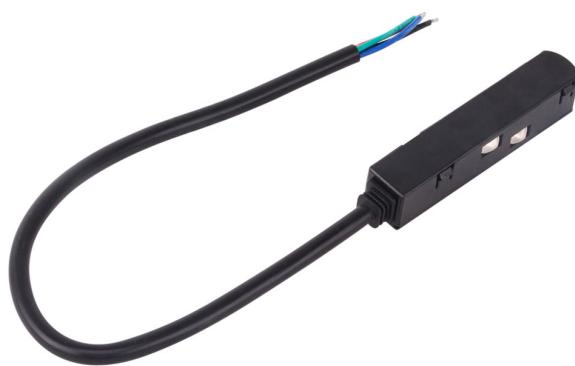
Alimentador para trilho magnético LINK. Corpo em polímero com acabamento preto. Grau de proteção IP-20. Alimentar com fonte 48Vcc. (Contatos próprios para ser montado no trilho magnético LINK).
