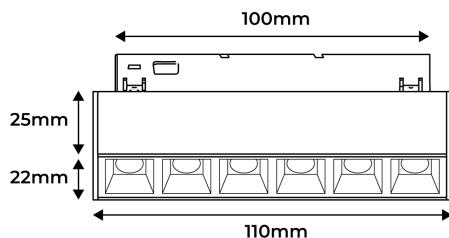
Luminária multifoco para trilho magnético LINK, 6W 3000K IRC>90. Corpo em alumínio. Acabamento preto. Controle óptico principal através de shade preto + lente. Luminária grau de proteção IP-20. Alimentação 48Vcc. (Necessita fonte com saída 48Vcc na montagem do trilho qual a luminária será instalada).
