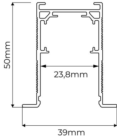
Trilho magnético LINK de embutir. Corpo em alumínio com acabamento preto. Tampa em polímero com acabamento preto. Grau de proteção IP-20. (Necessita fonte com saída 48Vcc na montagem do trilho qual a luminária será instalada).
