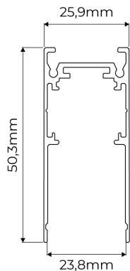
Trilho magnético LINK pendente. Corpo em alumínio com acabamento branco. Tampa em polímero com acabamento branco. Grau de proteção IP-20. (Necessita fonte com saída 48Vcc na montagem do trilho qual a luminária será instalada).
