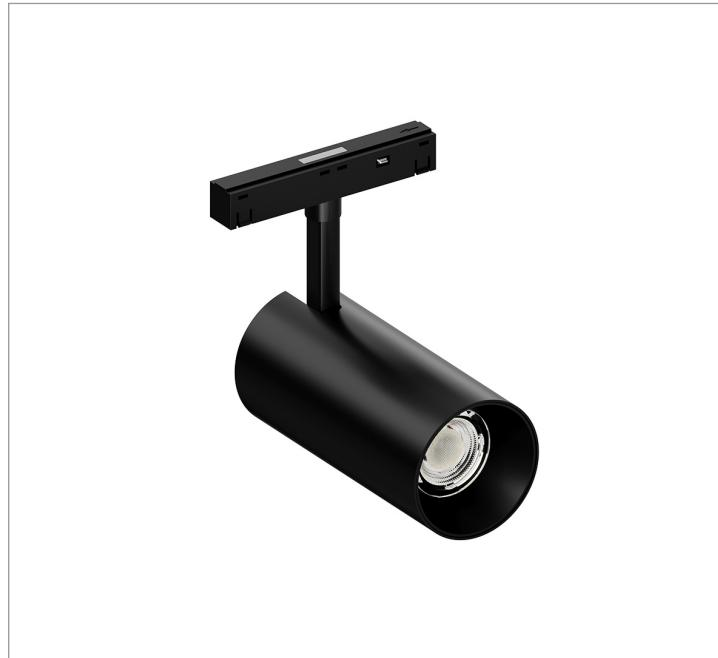
Luminária spot para trilho magnético LINK, 10W 3000K IRC>90. Corpo em alumínio. Acabamento branco. Controle óptico principal através de lente + recuo branco. Luminária grau de proteção IP-20. Alimentação 48Vcc. (Necessita fonte com saída 48Vcc na montagem do trilho qual a luminária será instalada).
