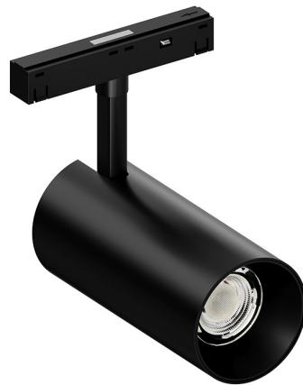
Luminária spot para trilho magnético LINK, 20W 3000K IRC>90. Corpo em alumínio. Acabamento preto. Controle óptico principal através de lente + recuo preto. Luminária grau de proteção IP-20. Alimentação 48Vcc. (Necessita fonte com saída 48Vcc na montagem do trilho qual a luminária será instalada).
