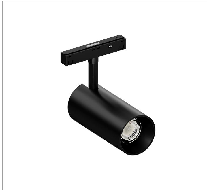
Luminária spot para trilho magnético LINK, 20W 3000K IRC>90. Corpo em alumínio. Acabamento preto. Controle óptico principal através de lente + recuo preto. Luminária grau de proteção IP-20. Alimentação 48Vcc. (Necessita fonte com saída 48Vcc na montagem do trilho qual a luminária será instalada).
