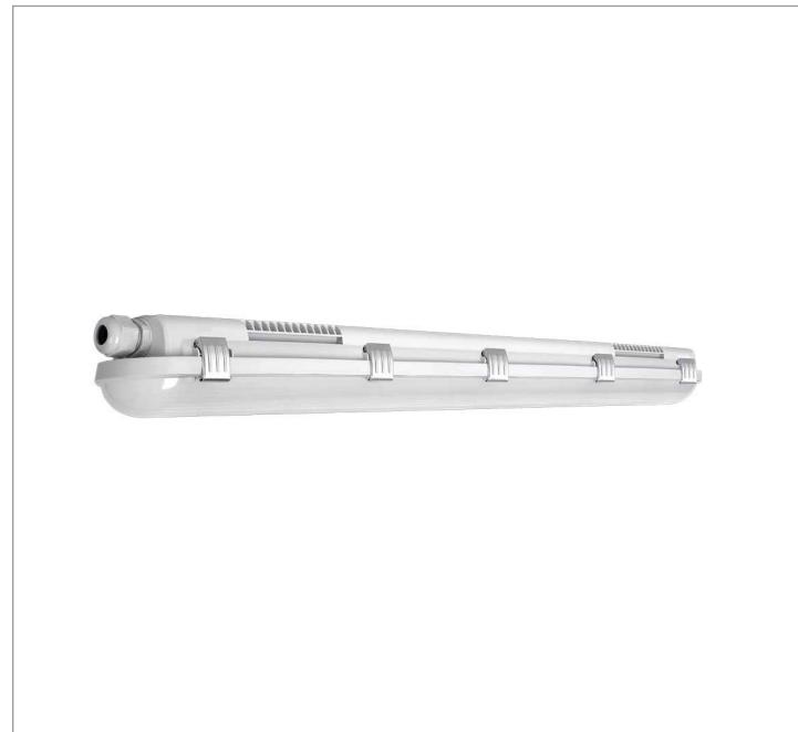
Luminária retangular para perfilado, 16W 5000K IRC>80. Corpo em policarbonato. Acabamento cinza. Controle óptico principal através de difusor em policarbonato translúcido. Luminária grau de proteção IP-65. Driver corrente constante Liga/Desliga, Triac, 1-10V ou Dali (consultar condições). Tensão de trabalho 220V ou Bivolt.
