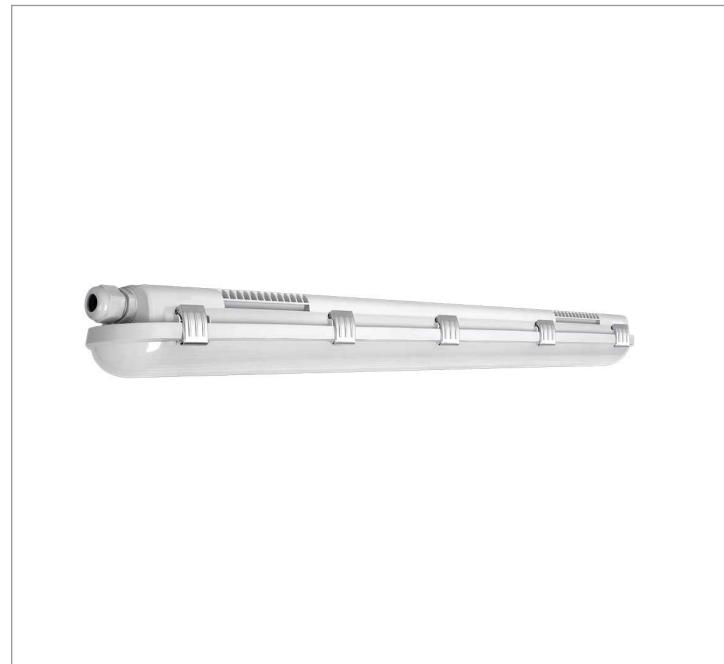
Luminária retangular para perfilado, 36W 5000K IRC>80. Corpo em policarbonato. Acabamento cinza. Controle óptico principal através de difusor em policarbonato translúcido. Luminária grau de proteção IP-65. Driver corrente constante Liga/Desliga, Triac, 1-10V ou Dali (consultar condições). Tensão de trabalho 220V ou Bivolt.
