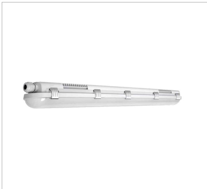
Luminária retangular de sobrepor, 16W 4000K IRC>80. Corpo em policarbonato. Acabamento cinza. Controle óptico principal através de difusor em policarbonato translúcido. Luminária grau de proteção IP-65. Driver corrente constante Liga/Desliga, Triac, 1-10V ou Dali (consultar condições). Tensão de trabalho 220V ou Bivolt.
