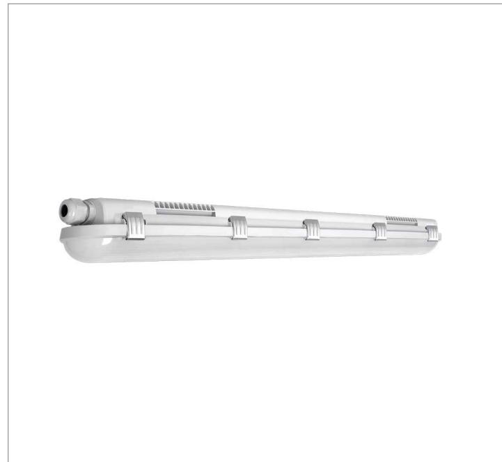
Luminária retangular de sobrepor, 54W 3000K IRC>80. Corpo em policarbonato. Acabamento cinza. Controle óptico principal através de difusor em policarbonato translúcido. Luminária grau de proteção IP-65. Driver corrente constante Liga/Desliga, Triac, 1-10V ou Dali (consultar condições). Tensão de trabalho 220V ou Bivolt.
