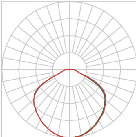
Luminária circular pendente iluminação direta, 14W 3000K IRC>80. Corpo em alumínio. Acabamento Branca, Preta ou Especial. Controle óptico principal através de refletor facho difuso. Luminária grau de proteção IP-20. Driver corrente constante Liga/Desliga, Triac, 1-10V ou Dali (consultar condições). Tensão de trabalho 220V ou Bivolt.
