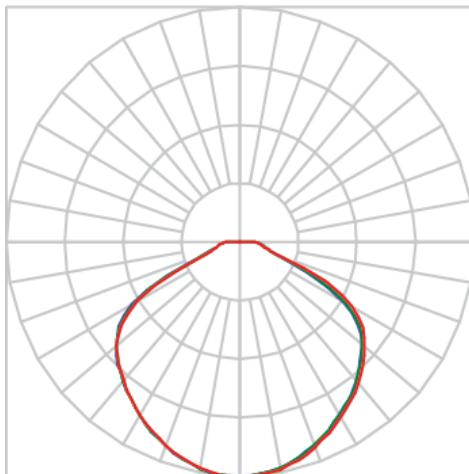
Luminária circular pendente iluminação direta, 20W 4000K IRC>80. Corpo em alumínio. Acabamento Branca, Preta ou Especial. Controle óptico principal através de refletor facho difuso. Luminária grau de proteção IP-20. Driver corrente constante Liga/Desliga, Triac, 1-10V ou Dali (consultar condições). Tensão de trabalho 220V ou Bivolt.
