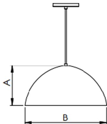
Luminária circular pendente iluminação direta, 28W 4000K IRC>80. Corpo em alumínio. Acabamento Branca, Preta ou Especial. Controle óptico principal através de refletor facho difuso. Luminária grau de proteção IP-20. Driver corrente constante Liga/Desliga, Triac, 1-10V ou Dali (consultar condições). Tensão de trabalho 220V ou Bivolt.
