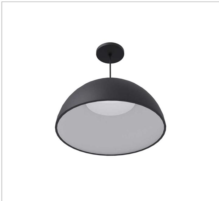
Luminária circular pendente iluminação direta, 7W 3000K IRC>80. Corpo em alumínio. Acabamento Branca, Preta ou Especial. Controle óptico principal através de refletor facho difuso. Luminária grau de proteção IP-20. Driver corrente constante Liga/Desliga, Triac, 1-10V ou Dali (consultar condições). Tensão de trabalho 220V ou Bivolt.
