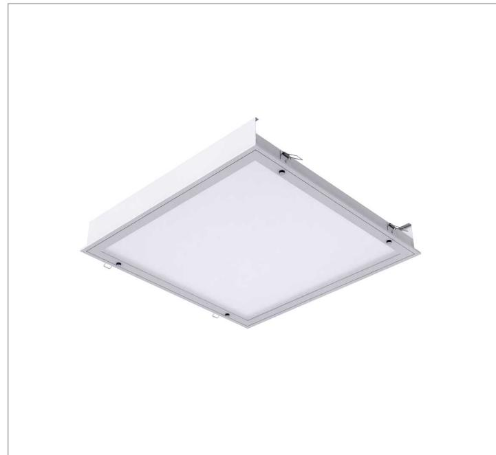
Luminária quadrada de embutir em forro de gesso, 40W 3000K IRC>80. Corpo em alumínio. Acabamento Branca, Preta ou Especial. Controle óptico principal através de difusor em poliestireno translúcido. Luminária grau de proteção IP-20. Driver corrente constante Liga/Desliga, Triac, 1-10V ou Dali (consultar condições). Tensão de trabalho 220V ou Bivolt.
