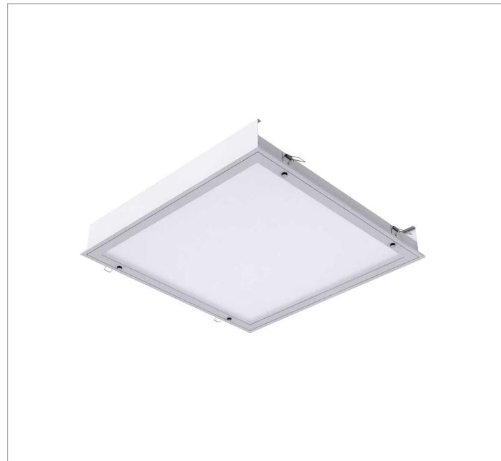
Luminária quadrada de embutir em forro de gesso, 40W 4000K IRC>80. Corpo em alumínio. Acabamento Branca, Preta ou Especial. Controle óptico principal através de difusor em poliestireno translúcido. Luminária grau de proteção IP-20. Driver corrente constante Liga/Desliga, Triac, 1-10V ou Dali (consultar condições). Tensão de trabalho 220V ou Bivolt.
