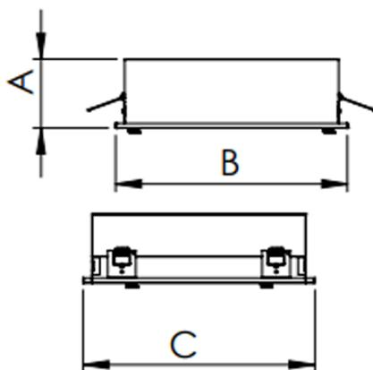
Luminária quadrada de embutir em forro modulado, 34W 4000K IRC>80. Corpo em alumínio. Acabamento Branca, Preta ou Especial. Controle óptico principal através de difusor em poliestireno translúcido. Luminária grau de proteção IP-20. Driver corrente constante Liga/Desliga, Triac, 1-10V ou Dali (consultar condições). Tensão de trabalho 220V ou Bivolt.
