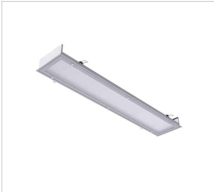
Luminária retangular de embutir em forro de gesso, 40W 5000K IRC>80. Corpo em alumínio. Acabamento Branca, Preta ou Especial. Controle óptico principal através de difusor em poliestireno translúcido. Luminária grau de proteção IP-20. Driver corrente constante Liga/Desliga, Triac, 1-10V ou Dali (consultar condições). Tensão de trabalho 220V ou Bivolt.
