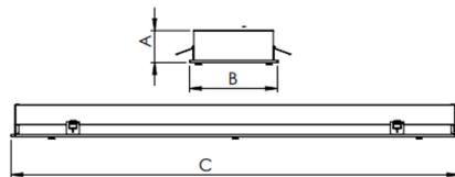
Luminária retangular de embutir em forro modulado, 20W 2700K IRC>80. Corpo em alumínio. Acabamento Branca, Preta ou Especial. Controle óptico principal através de difusor em poliestireno translúcido. Luminária grau de proteção IP-20. Driver corrente constante Liga/Desliga, Triac, 1-10V ou Dali (consultar condições). Tensão de trabalho 220V ou Bivolt.
