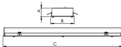
Luminária retangular de embutir em forro modulado, 20W 3000K IRC>80. Corpo em alumínio. Acabamento Branca, Preta ou Especial. Controle óptico principal através de difusor em poliestireno translúcido. Luminária grau de proteção IP-20. Driver corrente constante Liga/Desliga, Triac, 1-10V ou Dali (consultar condições). Tensão de trabalho 220V ou Bivolt.
