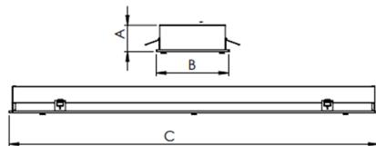
Luminária retangular de embutir em forro modulado, 34W 2700K IRC>80. Corpo em alumínio. Acabamento Branca, Preta ou Especial. Controle óptico principal através de difusor em poliestireno translúcido. Luminária grau de proteção IP-20. Driver corrente constante Liga/Desliga, Triac, 1-10V ou Dali (consultar condições). Tensão de trabalho 220V ou Bivolt.
