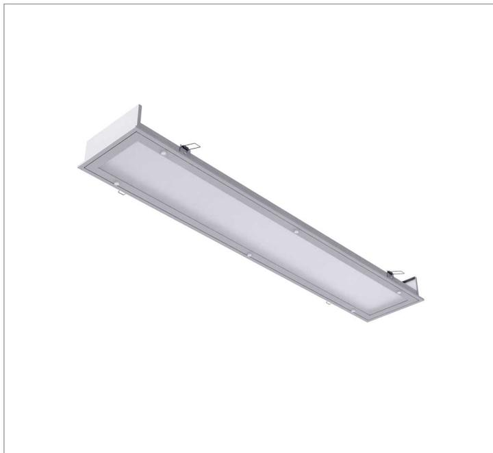
Luminária retangular de embutir em forro modulado, 34W 3000K IRC>80. Corpo em alumínio. Acabamento Branca, Preta ou Especial. Controle óptico principal através de difusor em poliestireno translúcido. Luminária grau de proteção IP-20. Driver corrente constante Liga/Desliga, Triac, 1-10V ou Dali (consultar condições). Tensão de trabalho 220V ou Bivolt.
