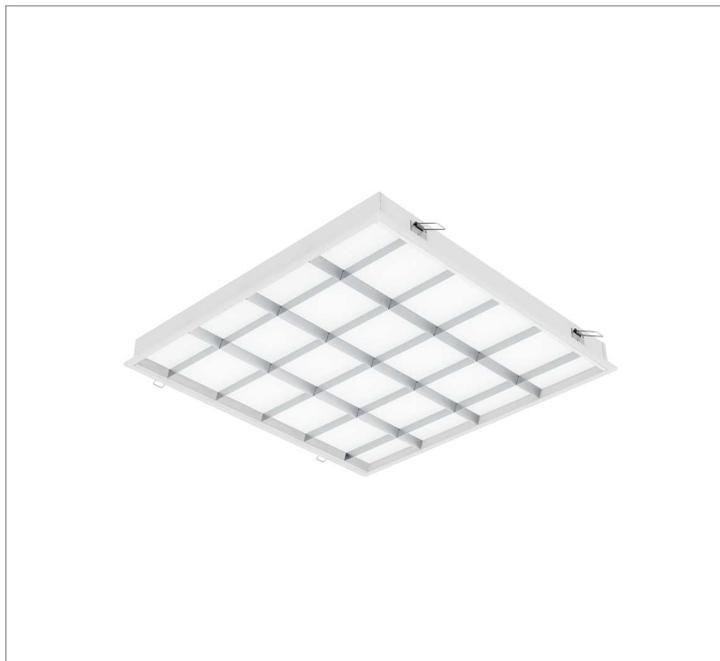
Luminária quadrada de embutir em forro modulado, 40W 5000K IRC>80. Corpo em alumínio. Acabamento Branca, Preta ou Especial. Controle óptico principal através de fecho difuso. Luminária grau de proteção IP-20. Driver corrente constante Liga/Desliga, Triac, 1-10V ou Dali (consultar condições). Tensão de trabalho 220V ou Bivolt.
