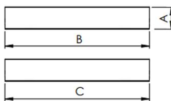
Luminária quadrada de sobrepor, 40W 5000K IRC>80. Corpo em alumínio. Acabamento Branca, Preta ou Especial. Controle óptico principal através de facho difuso. Luminária grau de proteção IP-20. Driver corrente constante Liga/Desliga, Triac, 1-10V ou Dali (consultar condições). Tensão de trabalho 220V ou Bivolt.
