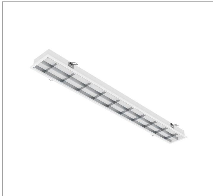
Luminária retangular de embutir em forro de gesso, 20W 2700K IRC>80. Corpo em alumínio. Acabamento Branca, Preta ou Especial. Controle óptico principal através de facho difuso. Luminária grau de proteção IP-20. Driver corrente constante Liga/Desliga, Triac, 1-10V ou Dali (consultar condições). Tensão de trabalho 220V ou Bivolt.
