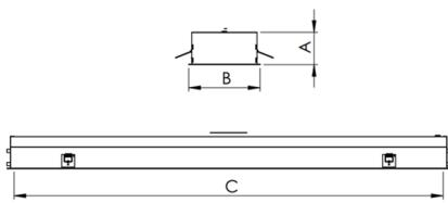
Luminária retangular de embutir em forro de gesso, 40W 3000K IRC>80. Corpo em alumínio. Acabamento Branca, Preta ou Especial. Controle óptico principal através de facho difuso. Luminária grau de proteção IP-20. Driver corrente constante Liga/Desliga, Triac, 1-10V ou Dali (consultar condições). Tensão de trabalho 220V ou Bivolt.
