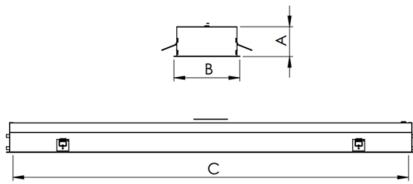
Luminária retangular de embutir em forro modulado, 20W 3000K IRC>80. Corpo em alumínio. Acabamento Branca, Preta ou Especial. Controle óptico principal através de facho difuso. Luminária grau de proteção IP-20. Driver corrente constante Liga/Desliga, Triac, 1-10V ou Dali (consultar condições). Tensão de trabalho 220V ou Bivolt.
