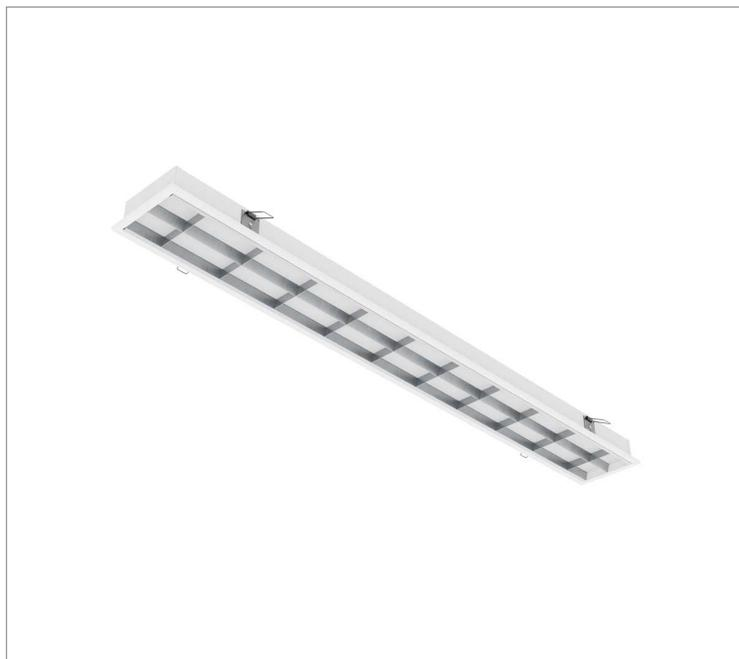
Luminária retangular de embutir em forro modulado, 40W 4000K IRC>80. Corpo em alumínio. Acabamento Branca, Preta ou Especial. Controle óptico principal através de facho difuso. Luminária grau de proteção IP-20. Driver corrente constante Liga/Desliga, Triac, 1-10V ou Dali (consultar condições). Tensão de trabalho 220V ou Bivolt.
