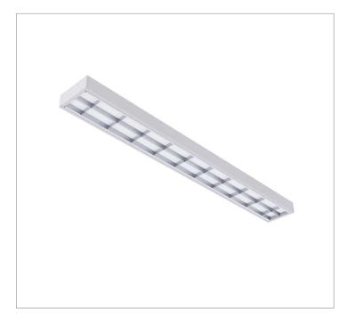
Luminária retangular de sobrepor, 40W 4000K IRC>80. Corpo em alumínio. Acabamento Branca, Preta ou Especial. Controle óptico principal através de facho difuso. Luminária grau de proteção IP-20. Driver corrente constante Liga/Desliga, Triac, 1-10V ou Dali (consultar condições). Tensão de trabalho 220V ou Bivolt.
