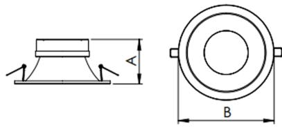
Luminária circular de embutir em forro de gesso, 14W 2700K IRC>80. Corpo em alumínio. Acabamento Preta. Controle óptico principal através de difusor em acrílico translúcido. Luminária grau de proteção IP-20. Driver corrente constante Liga/Desliga, Triac, 1-10V ou Dali (consultar condições). Tensão de trabalho 220V ou Bivolt.
