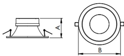
Luminária circular de embutir em forro de gesso, 14W 3000K IRC>80. Corpo em alumínio. Acabamento Branca. Controle óptico principal através de difusor em acrílico translúcido. Luminária grau de proteção IP-20. Driver corrente constante Liga/Desliga, Triac, 1-10V ou Dali (consultar condições). Tensão de trabalho 220V ou Bivolt.
