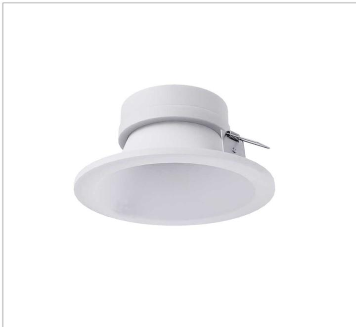
Luminária circular de embutir em forro de gesso, 28W 5000K IRC>80. Corpo em alumínio. Acabamento Branca. Controle óptico principal através de difusor em acrílico translúcido. Luminária grau de proteção IP-20. Driver corrente constante Liga/Desliga, Triac, 1-10V ou Dali (consultar condições). Tensão de trabalho 220V ou Bivolt.
