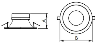
Luminária circular de embutir em forro de gesso, 14W 5000K IRC>80. Corpo em alumínio. Acabamento Preta. Controle óptico principal através de difusor em poliestireno translúcido. Luminária grau de proteção IP-20. Driver corrente constante Liga/Desliga, Triac, 1-10V ou Dali (consultar condições). Tensão de trabalho 220V ou Bivolt.
