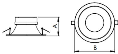
Luminária circular de embutir em forro de gesso, 28W 2700K IRC>80. Corpo em alumínio. Acabamento Preta. Controle óptico principal através de difusor em poliestireno translúcido. Luminária grau de proteção IP-20. Driver corrente constante Liga/Desliga, Triac, 1-10V ou Dali (consultar condições). Tensão de trabalho 220V ou Bivolt.
