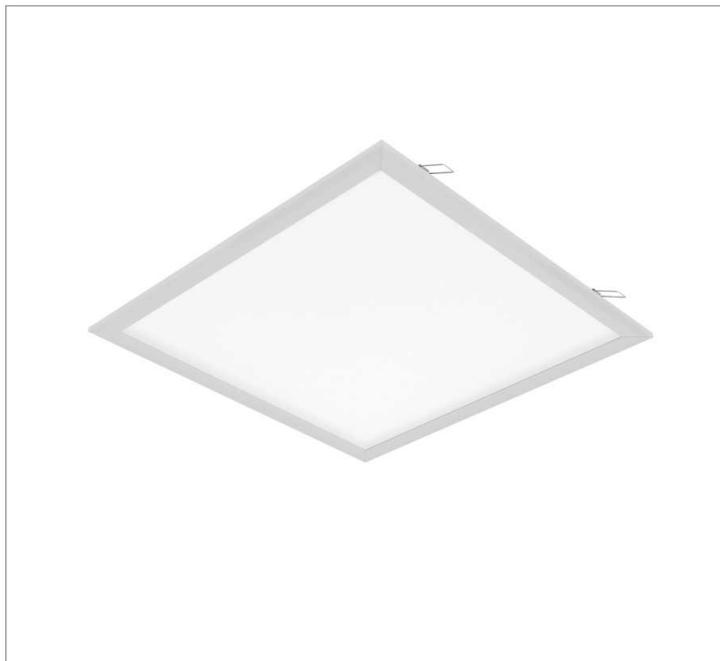
Luminária quadrada de embutir em forro de gesso, 34W 4000K IRC>80. Corpo em alumínio. Acabamento Branca, Preta ou Especial. Controle óptico principal através de difusor em poliestireno translúcido. Luminária grau de proteção IP-20. Driver corrente constante Liga/Desliga, Triac, 1-10V ou Dali (consultar condições). Tensão de trabalho 220V ou Bivolt.
