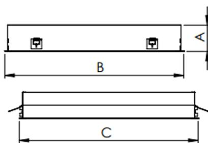
Luminária quadrada de embutir em forro de gesso, 40W 4000K IRC>80. Corpo em alumínio. Acabamento Branca, Preta ou Especial. Controle óptico principal através de difusor em poliestireno translúcido. Luminária grau de proteção IP-20. Driver corrente constante Liga/Desliga, Triac, 1-10V ou Dali (consultar condições). Tensão de trabalho 220V ou Bivolt.
