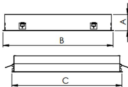
Luminária quadrada de embutir em forro modulado, 34W 3000K IRC>80. Corpo em alumínio. Acabamento Branca, Preta ou Especial. Controle óptico principal através de difusor em poliestireno translúcido. Luminária grau de proteção IP-20. Driver corrente constante Liga/Desliga, Triac, 1-10V ou Dali (consultar condições). Tensão de trabalho 220V ou Bivolt.
