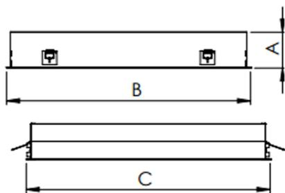
Luminária quadrada de embutir em forro modulado, 34W 4000K IRC>80. Corpo em alumínio. Acabamento Branca, Preta ou Especial. Controle óptico principal através de difusor em poliestireno translúcido. Luminária grau de proteção IP-20. Driver corrente constante Liga/Desliga, Triac, 1-10V ou Dali (consultar condições). Tensão de trabalho 220V ou Bivolt.
