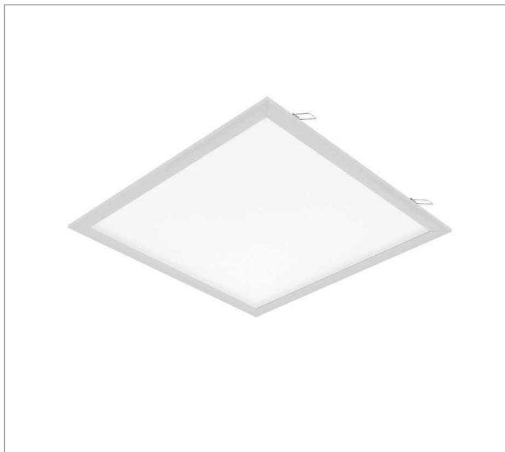
Luminária quadrada de embutir em forro modulado, 40W 3000K IRC>80. Corpo em alumínio. Acabamento Branca, Preta ou Especial. Controle óptico principal através de difusor em poliestireno translúcido. Luminária grau de proteção IP-20. Driver corrente constante Liga/Desliga, Triac, 1-10V ou Dali (consultar condições). Tensão de trabalho 220V ou Bivolt.
