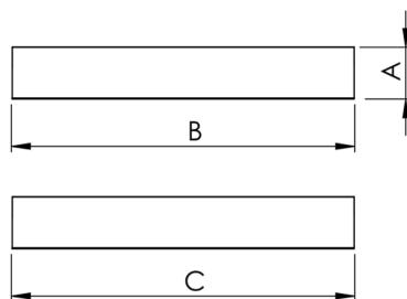
Luminária quadrada de sobrepor, 34W 3000K IRC>80. Corpo em alumínio. Acabamento Branca, Preta ou Especial. Controle óptico principal através de difusor em poliestireno translúcido. Luminária grau de proteção IP-20. Driver corrente constante Liga/Desliga, Triac, 1-10V ou Dali (consultar condições). Tensão de trabalho 220V ou Bivolt.
