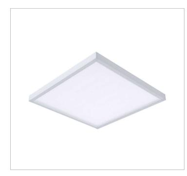
Luminária quadrada de sobrepor, 34W 4000K IRC>80. Corpo em alumínio. Acabamento Branca, Preta ou Especial. Controle óptico principal através de difusor em poliestireno translúcido. Luminária grau de proteção IP-20. Driver corrente constante Liga/Desliga, Triac, 1-10V ou Dali (consultar condições). Tensão de trabalho 220V ou Bivolt.
