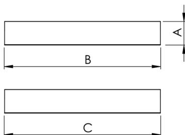
Luminária quadrada de sobrepor, 40W 4000K IRC>80. Corpo em alumínio. Acabamento Branca, Preta ou Especial. Controle óptico principal através de difusor em poliestireno translúcido. Luminária grau de proteção IP-20. Driver corrente constante Liga/Desliga, Triac, 1-10V ou Dali (consultar condições). Tensão de trabalho 220V ou Bivolt.
