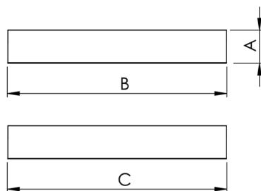
Luminária quadrada de sobrepor, 56W 4000K IRC>80. Corpo em alumínio. Acabamento Branca, Preta ou Especial. Controle óptico principal através de difusor em poliestireno translúcido. Luminária grau de proteção IP-20. Driver corrente constante Liga/Desliga, Triac, 1-10V ou Dali (consultar condições). Tensão de trabalho 220V ou Bivolt.
