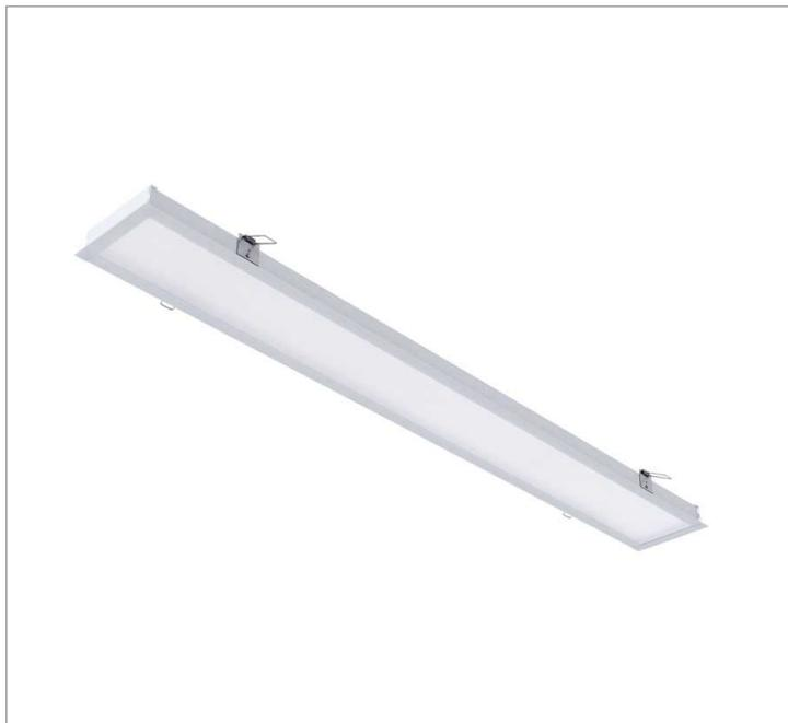
Luminária retangular de embutir em forro de gesso, 20W 3000K IRC>80. Corpo em alumínio. Acabamento Branca, Preta ou Especial. Controle óptico principal através de difusor em poliestireno translúcido. Luminária grau de proteção IP-20. Driver corrente constante Liga/Desliga, Triac, 1-10V ou Dali (consultar condições). Tensão de trabalho 220V ou Bivolt.
