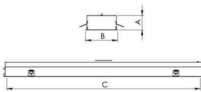
Luminária retangular de embutir em forro de gesso, 34W 4000K IRC>80. Corpo em alumínio. Acabamento Branca, Preta ou Especial. Controle óptico principal através de difusor em poliestireno translúcido. Luminária grau de proteção IP-20. Driver corrente constante Liga/Desliga, Triac, 1-10V ou Dali (consultar condições). Tensão de trabalho 220V ou Bivolt.
