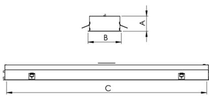
Luminária retangular de embutir em forro de gesso, 40W 4000K IRC>80. Corpo em alumínio. Acabamento Branca, Preta ou Especial. Controle óptico principal através de difusor em poliestireno translúcido. Luminária grau de proteção IP-20. Driver corrente constante Liga/Desliga, Triac, 1-10V ou Dali (consultar condições). Tensão de trabalho 220V ou Bivolt.
